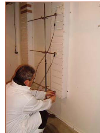
Mesures en différents points des vitesses d'air à la sortie des gaines d'aération du séchoir
